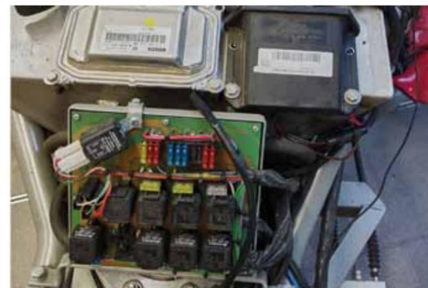
Rewaco: dispositif électrique central avec appareils de commande et boîtier à fusibles
