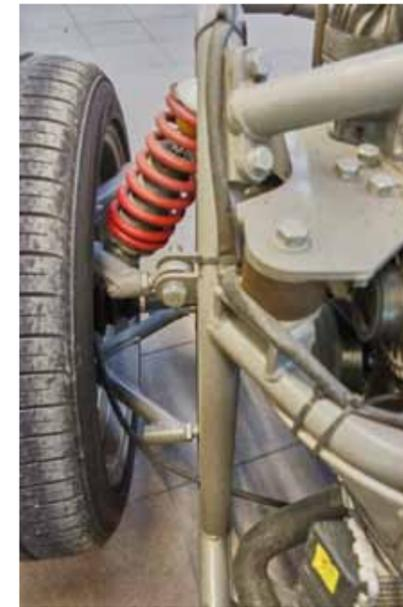
**Rewaco : doubles bras transversaux avec suspension réglable Bilstein**
