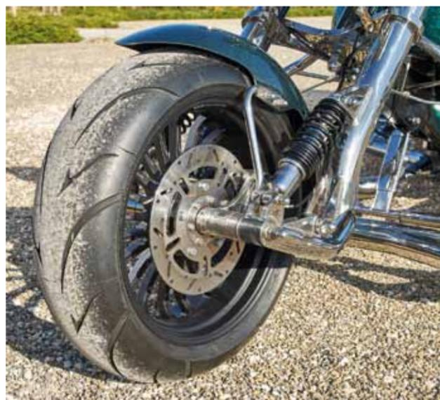
Boom: disque de frein intégré dans le creux de la jante avec étrier Grimeca et jante alu 5,5Jx17; meilleure réactivité sur les chaussées mouillées
