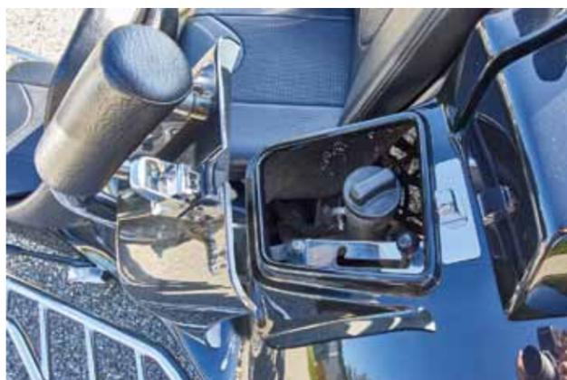
Rewaco: l'accès au réservoir est placé sous un clapet verrouillable qui se rabat en même temps que l'accoudoir
