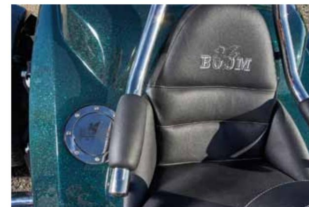
Boom: les sièges tout confort sont fixés par rivets. Un orifice permet à l'eau de pluie de s'écouler
