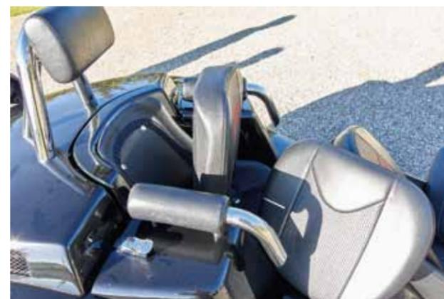
Rewaco: coussins de siège amovibles et l'accès pour la maintenance se trouve sous la coque d'assise dévissable
